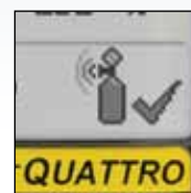
Einfache visuelle Funktionskontrolle
